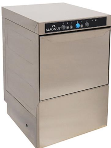
Carroçaria, braços e injetores em aço inoxidável; porta de parede dupla; abastecimento de água automático; enxaguamento com água quente através de sistema [?]thermostop[?]; doseador abrillantador incorporado; termóstato regulável para cuba e caldeira, dispositivo de segurança na porta; painel de comandos extraível; grupo de drenagem da água do tanque e esgoto estão integrados para total esvaziamento do circuito de lavagem (drenagem por gravidade); válvula anti-retorno de água.
