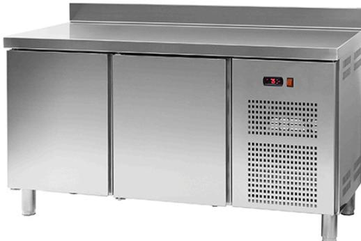
Interior y exterior en acero inox, excepto panel posterior en galvanizado. Ángulos y fondo redondeados. Aislamiento en poliuretano inyectado con densidad 40kg/m<sup>3</sup>, sin CFC. Frio ventilado. Termostato electrónico digital. Puertas con dispositivo automático de cierre y fijación de apertura. Evaporación automática de agua de condensación. Evaporador con tratamiento anti-corrosión. Fondo con orificio para drenaje de agua. Pies regulables en altura.
