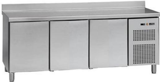
Interior y exterior en acero inox, excepto panel posterior en galvanizado. Ángulos y fondo redondeados. Aislamiento en poliuretano inyectado con densidad 40kg/m<sup>3</sup>, sin CFC. Frio ventilado. Termostato electrónico digital. Puertas con dispositivo automático de cierre y fijación de apertura. Evaporación automática de agua de condensación. Evaporador con tratamiento anti-corrosión. Fondo con orificio para drenaje de agua. Pies regulables en altura.
