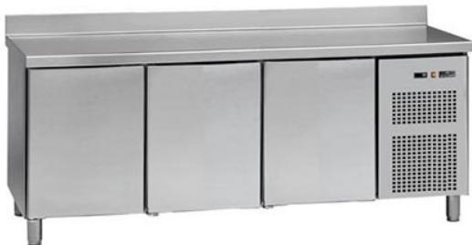
Interior y exterior en acero inox, excepto panel posterior en galvanizado. Ángulos y fondo redondeados. Aislamiento en poliuretano inyectado con densidad 40kg/m3, sin CFC. Frio ventilado. Termostato electrónico digital. Puertas con dispositivo automático de cierre y fijación de apertura. Evaporación automática de agua de condensación. Evaporador con tratamiento anti-corrosión. Fondo con orificio para drenaje de agua. Pies regulables en altura.
