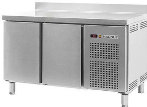
Interior y exterior en acero inox, excepto panel posterior en galvanizado; ángulos y fondo redondeados; aislamiento en poliuretano inyectado, densidad 40kg/m<sup>3</sup>, sin CFC; termostato electrónico digital; puertas con dispositivo automático de cierre y fijación de apertura; evaporación automática de agua de condensación; evaporador con tratamiento anti-corrosión; fondo con orificio para drenaje de agua; pies en acero inoxidable regulables en altura.
