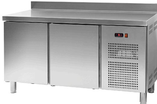
Interior y exterior en acero inox, excepto panel posterior en galvanizado; ángulos y fondo redondeados; aislamiento en poliuretano inyectado de 50 mm, densidad 40kg/m<sup>3</sup>, sin CFC; frío ventilado; termostato electrónico digital; puertas con dispositivo automático de cierre y fijación de apertura; evaporación automática de agua de condensación; evaporador con tratamiento anti-corrosión; fondo con orificio para drenaje de agua; pies regulables en altura.
