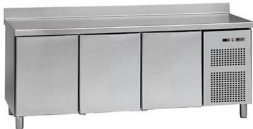
Interior y exterior en acero inox, excepto panel posterior en galvanizado; ángulos y fondo redondeados; aislamiento en poliuretano inyectado de 50 mm, densidad 40kg/m3, sin CFC; frío ventilado; termostato electrónico digital; puertas con dispositivo automático de cierre y fijación de apertura; evaporación automática de agua de condensación; evaporador con tratamiento anti-corrosión; fondo con orificio para drenaje de agua; pies regulables en altura.
