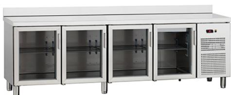
Interior y exterior en acero inox, excepto panel posterior en galvanizado. Ángulos y fondo redondeados. Aislamiento en poliuretano inyectado con densidad 40kg/m<sup>3</sup>, sin CFC. Frio ventilado. Termostato electrónico digital. Puertas con dispositivo automático de cierre y fijación de apertura. Evaporación automática de agua de condensación. Evaporador con tratamiento anti-corrosión. Fondo con orificio para drenaje de agua. Pies regulables en altura.
