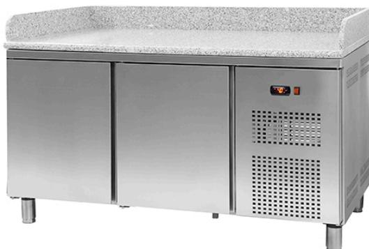
Interior y exterior en acero inox, excepto panel posterior en galvanizado; ángulos y fondo redondeados; aislamiento en poliuretano inyectado, densidad 40kg/m3, sin CFC; termostato electrónico digital; puertas con dispositivo automático de cierre y fijación de apertura; evaporación automática de agua de condensación; evaporador con tratamiento anti-corrosión; fondo con orificio para drenaje de agua; pies en acero inoxidable regulables en altura.
