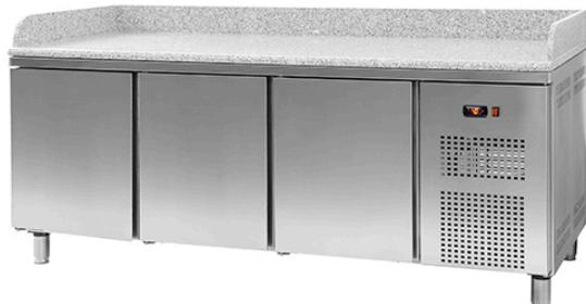
Interior y exterior en acero inox, excepto panel posterior en galvanizado; ángulos y fondo redondeados; aislamiento en poliuretano inyectado, densidad 40kg/m3, sin CFC; termostato electrónico digital; puertas con dispositivo automático de cierre y fijación de apertura; evaporación automática de agua de condensación; evaporador con tratamiento anti-corrosión; fondo con orificio para drenaje de agua; pies en acero inoxidable regulables en altura.
