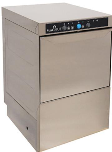
Carrocería de acero inoxidable; brazos e inyectores en materiales compuestos; puerta de pared doble; abastecimiento de agua automática; aclarado con agua caliente a través de sistema [?]thermostop[?]; dosificador de abrillantador incorporado; termostato regulable para cuba y caldera; dispositivo de seguridad en la puerta; panel de mandos extraíble; grupo de succión de agua del tanque y desagüe están integrados para el drenaje total del circuito de lavado (drenaje por gravedad).
