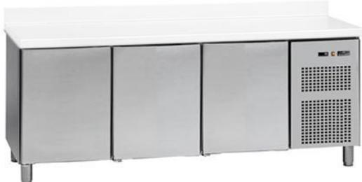
Interior y exterior en acero inox, excepto panel posterior en galvanizado. Ángulos y fondo redondeados. Aislamiento en poliuretano inyectado con densidad 40kg/m3, sin CFC. Frio ventilado. Termostato electrónico digital. Puertas con dispositivo automático de cierre y fijación de apertura. Evaporación automática de agua de condensación. Evaporador con tratamiento anti-corrosión. Fondo con orificio para drenaje de agua. Pies regulables en altura.
