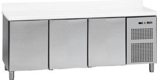
Interior y exterior en acero inox, excepto panel posterior en galvanizado. Ángulos y fondo redondeados. Aislamiento en poliuretano inyectado con densidad 40kg/m<sup>3</sup>, sin CFC. Frio ventilado. Termostato electrónico digital. Puertas con dispositivo automático de cierre y fijación de apertura. Evaporación automática de agua de condensación. Evaporador con tratamiento anti-corrosión. Fondo con orificio para drenaje de agua. Pies regulables en altura.
