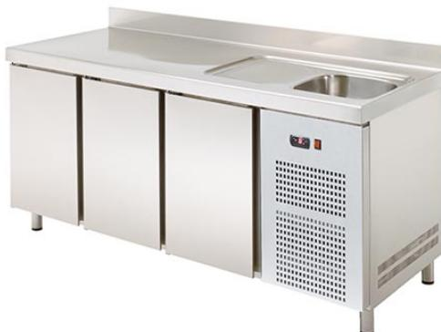
Interior y exterior en acero inox, excepto panel posterior en galvanizado. Ángulos y fondo redondeados. Aislamiento en poliuretano inyectado con densidad 40kg/m3, sin CFC. Frio ventilado. Termostato electrónico digital. Puertas con dispositivo automático de cierre y fijación de apertura. Evaporación automática de agua de condensación. Evaporador con tratamiento anti-corrosión. Fondo con orificio para drenaje de agua. Pies regulables en altura.
