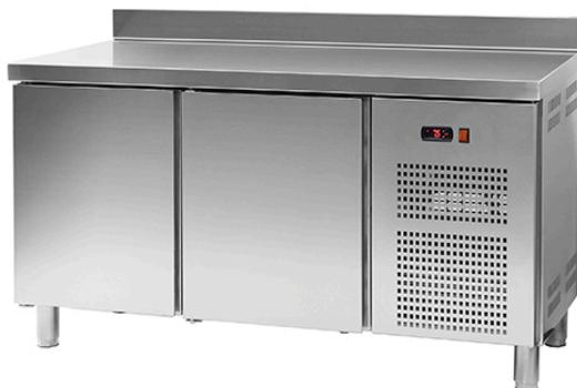
Interior e exterior em aço inoxidável, exceto painel posterior que é galvanizado. Ângulos, fundo e planos arredondados. Isolamento em poliuretano injetado com densidade 40 kg/m<sup>3</sup>, sem CFC. Frio ventilado. Controlo da temperatura com visor digital. Portas com dispositivo automático de fecho e fixação de abertura.
