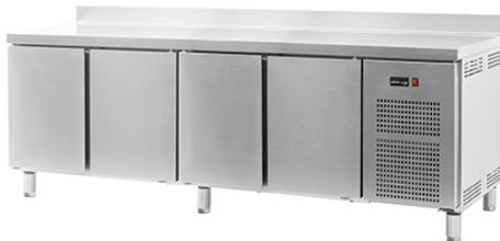
Interior e exterior em aço inoxidável, exceto painel posterior que é galvanizado; ângulos, fundo e planos arredondados; isolamento em poliuretano injetado com densidade 40 kg/m<sup>3</sup>, sem CFC; frio ventilado; termóstato eletrónico digital; portas com dispositivo automático de fecho e fixação de abertura; evaporação automática da água da condensação; evaporador com tratamento anti-corrosão; fundo com orifício para o escoamento de água; pés em aço inoxidável reguláveis em altura.
