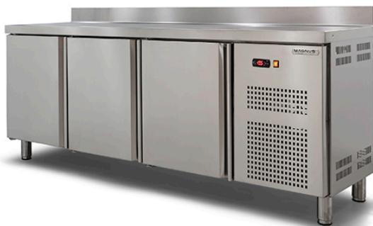
Interior e exterior em aço inoxidável, exceto painel posterior que é galvanizado. Ângulos, fundo e planos arredondados. Isolamento em poliuretano injetado com densidade 40 kg/m<sup>3</sup>, sem CFC. Frio ventilado. Controlo da temperatura com visor digital. Portas com dispositivo automático de fecho e fixação de abertura. Evaporação automática da água da condensação. Evaporador com tratamento anti-corrosão. Fundo com orifício para o escoamento de água. Pés em aço inoxidável reguláveis em altura.
