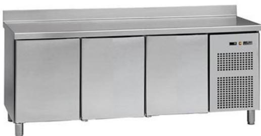
Interior e exterior em aço inoxidável, exceto painel posterior que é galvanizado; ângulos, fundo e planos arredondados; isolamento em poliuretano injetado com densidade 40 kg/m<sup>3</sup>, sem CFC; frio ventilado; termóstato eletrónico digital; portas com dispositivo automático de fecho e fixação de abertura; evaporação automática da água da condensação; evaporador com tratamento anti-corrosão; fundo com orifício para o escoamento de água; pés em aço inoxidável reguláveis em altura.
