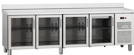
Interior e exterior em aço inoxidável, exceto painel posterior que é galvanizado. Ângulos, fundo e planos arredondados. Isolamento em poliuretano injetado com densidade 40 kg/m<sup>3</sup>, sem CFC. Frio ventilado. Termóstato eletrónico digital. Portas com dispositivo automático de fecho e fixação de abertura. Evaporação automática da água da condensação. Evaporador com tratamento anti-corrosão. Fundo com orifício para o escoamento de água. Pés em aço inoxidável reguláveis em altura.
