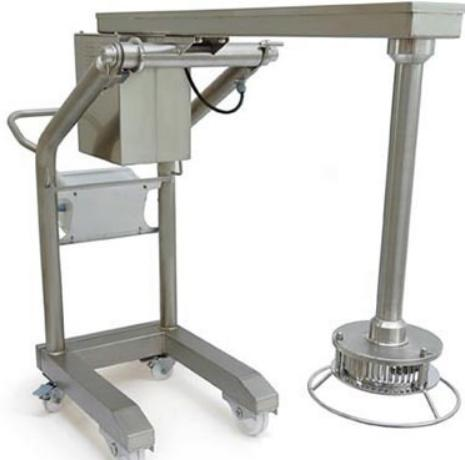
Construído totalmente em aço inoxidável 18/10.
