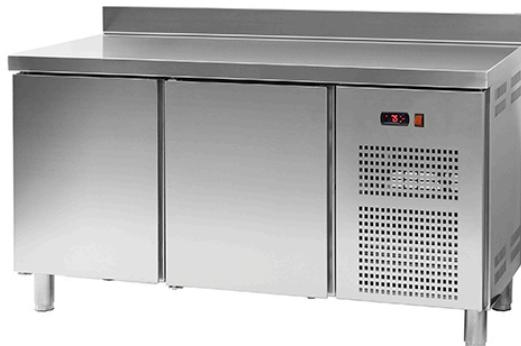
Interior e exterior em aço inoxidável, exceto painel posterior que é galvanizado. Ângulos, fundo e planos arredondados. Isolamento em poliuretano injetado com densidade 40 kg/m<sup>3</sup>, sem CFC. Frio ventilado. Controlo da temperatura com visor digital. Portas com dispositivo automático de fecho e fixação de abertura. Evaporação automática da água da condensação. Evaporador com tratamento anti-corrosão. Fundo com orifício para o escoamento de água. Pés em aço inoxidável reguláveis em altura.
