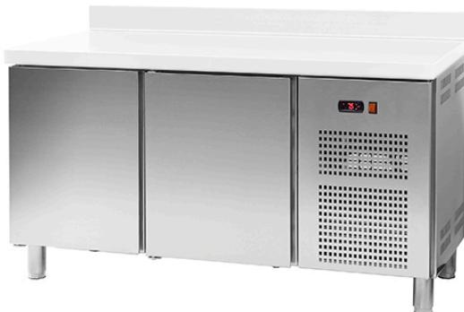
Interior e exterior em aço inoxidável, exceto painel posterior que é galvanizado. Ângulos, fundo e planos arredondados. Isolamento em poliuretano injetado com densidade 40 kg/m<sup>3</sup>, sem CFC. Frio ventilado. Termóstato eletrónico digital. Portas com dispositivo automático de fecho e fixação de abertura. Evaporação automática da água da condensação. Evaporador com tratamento anti-corrosão. Fundo com orifício para o escoamento de água. Pés em aço inoxidável reguláveis em altura.
